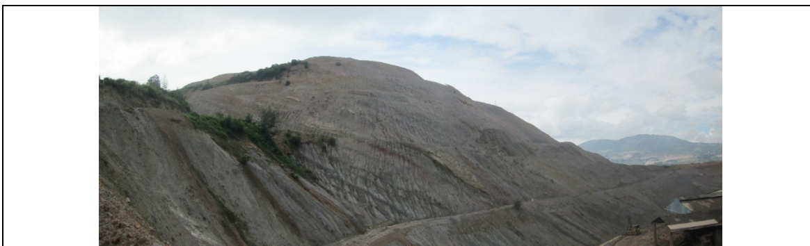
Fotografía No. 2. Sociedad Ladrillera Zigurat S.A.S. Se aprecia los taludes y bermas temporales del Frente Sur donde realizan actividades de explotación de minerales
